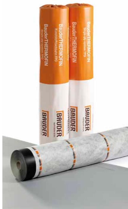
BauderTHERMOFIN F 15/18/20 V su sintetičke krovne membrane koje se proizvode u debljinama 1,5/1,8/2,0 mm sa ojačanjem od staklene tkanine i dodatno su s donje strane kaširane posebnom tkaninom. To im, osim pouzdanih svojstava standardnih membrana, daje i mogućnost lijepljenja sigurno od djelovanja vjetra pomoću dopuštenog PU ljepila.
