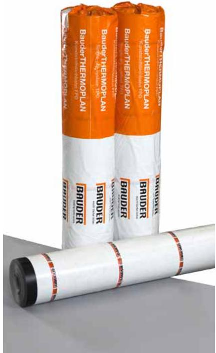
BauderTHERMOPLAN SK 15/18 su sintetičke krovne membrane koje se proizvode u debljinama od 1,5 do 1,8 mm. Ojačane su specijalnim ojačanjem od mrežice i staklene tkanine i dodatno s donje strane kaširane PES tkaninom i hladno samoljepljivim slojem.
