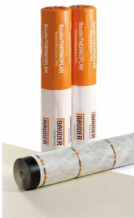
BauderTHERMOPLAN T 15/18/20 V su sintetičke krovne membrane koje se proizvode u debljinama od 1,5 do 2,0 mm. Ojačane su sintetičkom mrežicom i dodatno s donje strane kaširane posebnom tkaninom. To im, osim pouzdanih svojstava membrana ojačanih mrežicom, daje i mogućnost lijepljenja sigurno od djelovanja vjetra pomoću dopuštenog PU ljepila.
